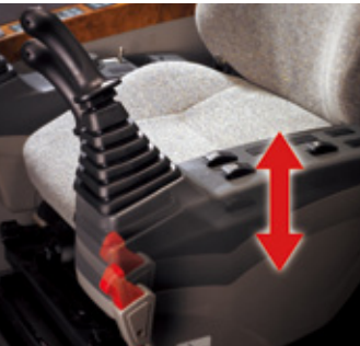
Pedestal de control (función telescópica)
