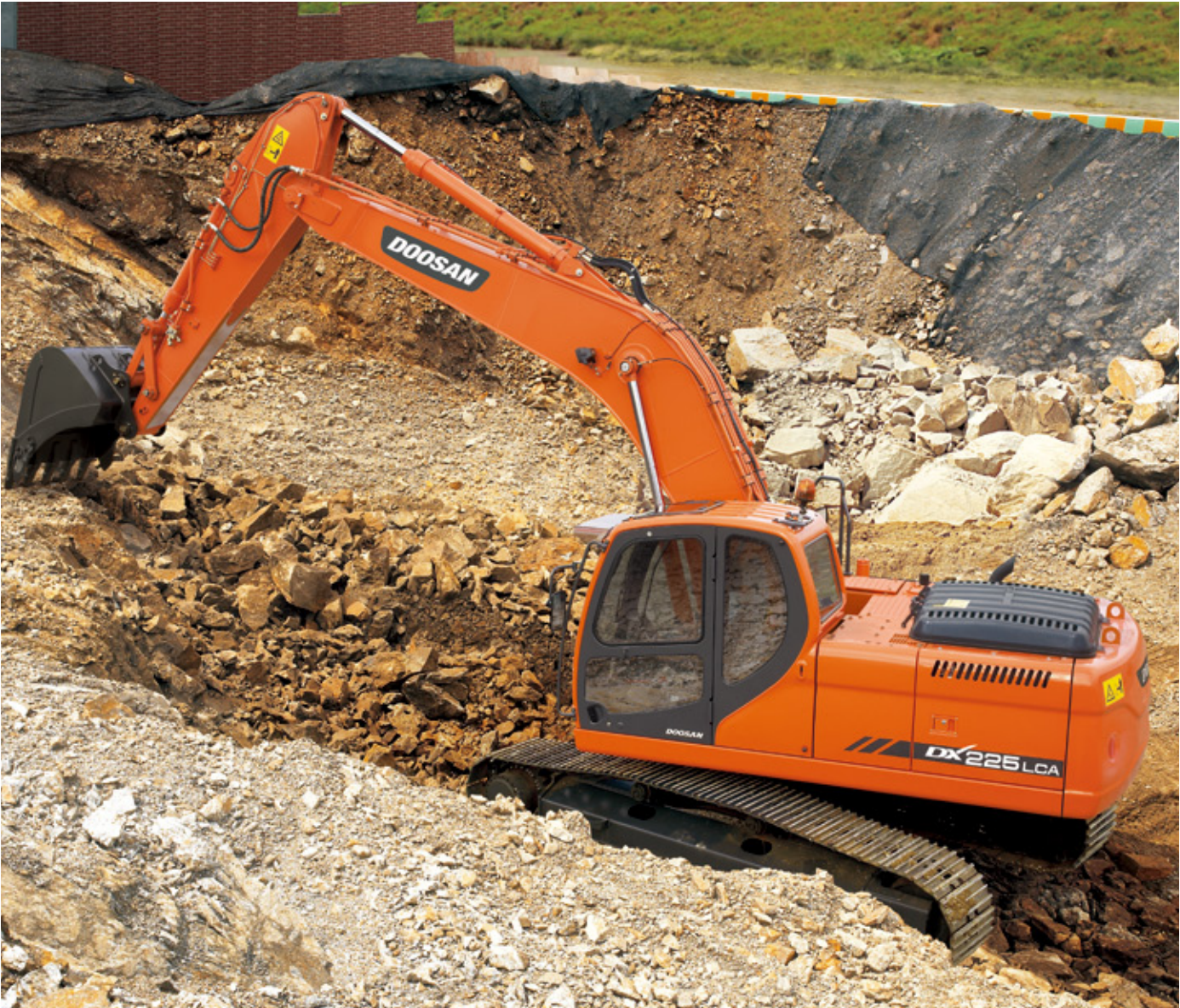
CONTROL DE LA EXCAVADORA Nuevo sistema e-EPOS (Sistema Electrónico de Optimización de Potencia) El cerebro de la excavadora hidráulica, el e-EPOS, ha sido mejorado a través de un enlace de comunicaciones de Red de Área de Controlador (CAN), que posibilita un intercambio continuo de información entre el motor y el sistema hidráulico. Dichas unidades se encuentran ahora perfectamente sincronizadas. Las ventajas del nuevo e-EPOS impactan en varios niveles. Facilidad de operación y manejo por el usuario: • La disponibilidad de un modo de potencia y un modo estándar garantiza la máxima eficiencia en todas las condiciones. • El modo de desaceleración automática posibilita el ahorro de combustible. • La regulación y el control preciso del caudal requerido por el equipo están disponibles como funciones estándar • Una función de autodiagnóstico permite resolver los problemas técnicos en forma rápida y eficiente. • Una memoria operacional proporciona una representación gráfica del estado de la máquina. • Se puede obtener la representación de los intervalos de mantenimiento y de cambio de aceite
